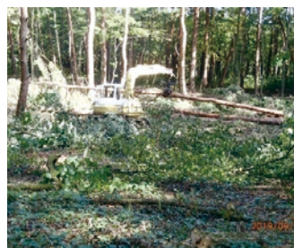
プロセッサ等による枝落としと玉切り作業
