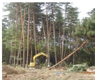
プロセッサ等による枝落としと玉切り作業
